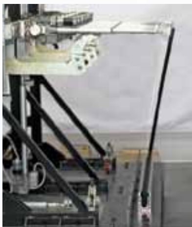
Deformación a 4.5 KN/m de carga
