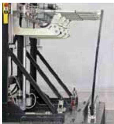
Deformación a 3 KN/m de carga
